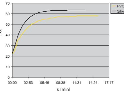
PVC phản ứng với nhiệt độ nước từ 22.5 1°C đến 58°C.
