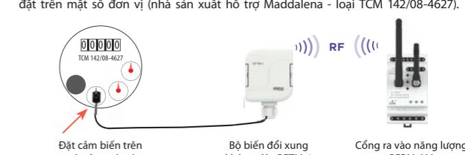
Đặt cảm biến trên máy đo nước Bộ biến đổi xung không dây RFPM-1 Cổng ra vào năng lượng RFPM-2M
