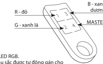
Chế độ RF RGB để điều khiển dải LED RGB.
