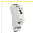
PRI-51 Giám sát dòng điện bằng biến áp tích hợp, 5 phạm vi (trong các phiên bản 1/2/5/8/16A), khoảng 5A thích hợp với máy biến áp dòng (X/5), Nguồn và đầu ra giống PRI-32, Khác với PRI-32: trực tiếp Theo dõi và phạm vi min hơn (độ nhạy cao hơn) = độ chính xác cao hơn khi đo lường.
