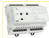
PRI-53 Dùng để giám sát dòng điện trong thiết bị 3 pha. Nguồn công suất: 24-240 V AC/DC, cách ly điện hóa từ mạch có dòng điện được theo dõi 2 loại phụ thuộc vào cường độ của dòng điện định mức In (1A, 5A).
