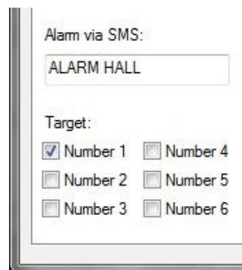
Abb. 32: Die Registerkarte "ARM / DISARM" - Eingabe des SMS-Textes und die Wahl von Telefonnummern.
