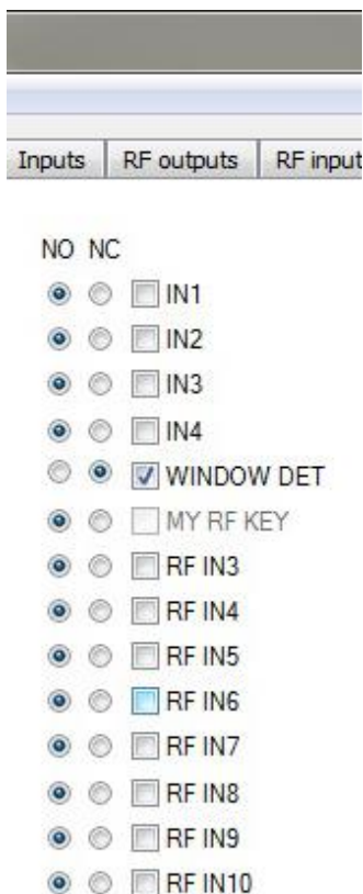
Abb. 30: Registerkarte "ARM/DISARM" - Auswahl von Eingängen der überwachten Zone und die Eingabe deren Standby.
