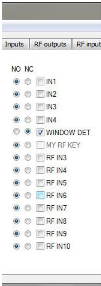
Рисунок 30: Вкладка "ARM/DISARM" – выбор входов контролируемой зоны и их режим ожидания.
